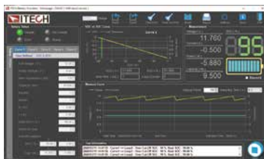
BSS2000电池模拟软件测试界面
