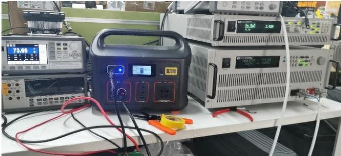
以应急电源为例,设备内置储能电池可采用交流或直流进行输入充电(如交流220V,车载12V等),输出为交流或直流(如交流220V,直流12V,直流5V,快充接口等)。
