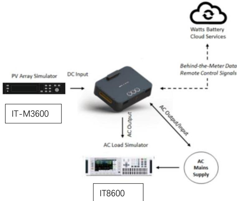
以图示结构，使用 IT-M3600 回馈式源载系统+ PV-SIM 软件模拟太阳能电池板给微型逆变器供电，可完成不同法规 EN50530/SANDIA/NB-T32004/CGC-GF004/CGC-GF035 下的 MPPT 效能测试；仿真不同温度及照度下的 I-V 曲线等。而针对太阳能电池板和组件的测试，ITECH 提供采样率达 50KHz 的负载，可为用户充分验证全天的 IV 输出特性曲线，并保存和记录所有数据，便于后期分析。此外，后端的 IT8600 交流电子负载，可以模拟各种家用电器，用于测试其输出性能。
