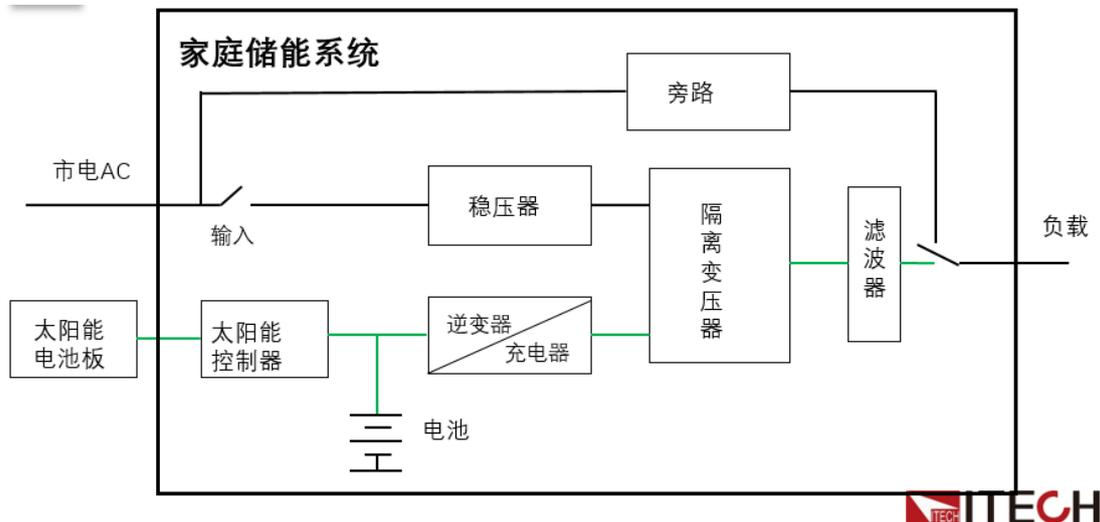
太阳能优先模式下,负载的供电全部由太阳能提供,如上图中绿色通路所示:当太阳能发出的电量可以满足用户负载时,则太阳能给负载供电,多余的太阳能给电池组充电;当太阳能发出的电量不能够满足用户负载时,由电池组补充给负载供电;当电池剩余容(SOC)小于等于10%时,系统会自动切换到市电给负载供电,并且会启动市电给电池充电,同时太阳能给电池充电,直到电池充满,充满后系统自动切换到太阳能和电池给负载供电。
