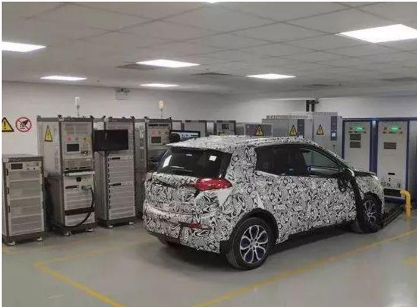
图 1 北汽新能源整车功率级 LabCar 自动化测试系统
