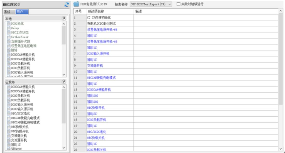
ITECH 车载充电机测试系统可以列出测试流程的项目需求,让使用者按不同产品的特性,将测试项目拖入测试序列中灵活的组合形成一个完整的测试序列,实现分段拉载,循环测试等不同工况。
