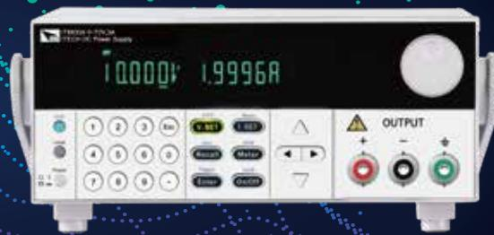
IT6900A系列宽范围可编程电源，内置标准RS232/USB/GPIB/RS485和模拟量接口（RS485和模拟量接口仅为IT6900B内置），支持SCPI协议，方便远程控制、工业PLC控制和组建智能化测试平台。其远程补偿端子，可避免导线上的压降引起的测试不精确问题。低涟波、低噪音以及内置数字电压表，方便外部量测。
