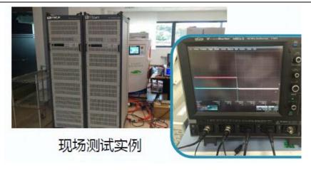
当对大功率充电桩进行测试时,一般会选择和充电桩功率匹配的单机电子负载,因为传 统模式下的电子负载,不支持 CV 模式并联。一旦多台电子负载 CV 模式下并联,就会很容 易出现并机的其中一台因吃载过大的电流而导致过功率烧机。但大功率电子负载一般费用较 高,重新购买设备的话,产品设计/制造成本就会增加。IT8900 系列在并机功能上更加完善, 它支持 CV 模式主从并联,功率最高可达 600KW。并机后所有操作只需在主机面板上设定, 主机自动分配给从机。在并机状态下,功能不受限制,可以用于 80KW 等大功率充电桩的 测试。用户无需多次购买设备,节约成本。同时内置多种通讯接口(LAN/USB/RS232/GPIB), 方便用户对产品进行远程控制,进行各种测试。
