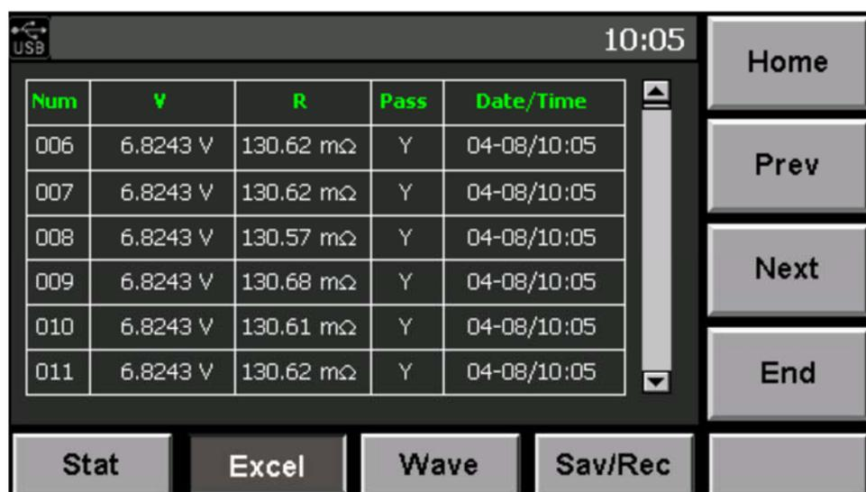
IT5101可以进行CSV格式的数据输出。IT5101带有USB接口，测量数据可以以CSV 文件格式保存在USB 存储设备中。用户可以把数据拷到电脑上，方便用户在计算机上浏览数据并对其进行分析。
