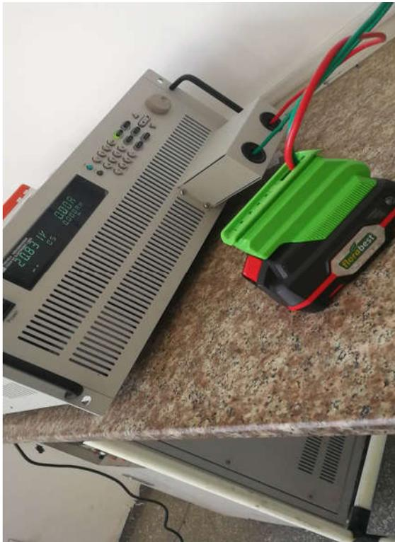
等待电池冷却后进行第二次放电测试，吸取上次的教训这次放电电流设置的比较低。整个过程没出现其他的问题，顺利测试通过。
