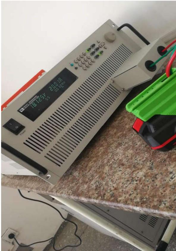
很快电池包电压下降到 15V，负载准确停止工作，整个放电过程很平滑很稳定，电池包只是正常发热。但在准备给电池充满电进行第二轮放电的时候问题出现了，电池包无法正常充电。正常充电时电池包的红色指示灯应处于常亮状态，可现在的红灯一直闪烁。
