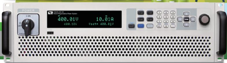
IT8000系列是一款紧凑型大功率能量回馈式直流电子负载，既能模拟各种负载特性，又能将电能无污染的回馈电网，不但为用户节省了用电和散热成本，同时也符合节能环保的需求。采用模块化高功率密度设计，3U体积内可提供高达18kW的功率吸收，通过主从并联、主动均流，可将功率扩展至2MW，特别适用于大功率电源、蓄电池、光伏电池、电动汽车、储能系统等测试领域。
